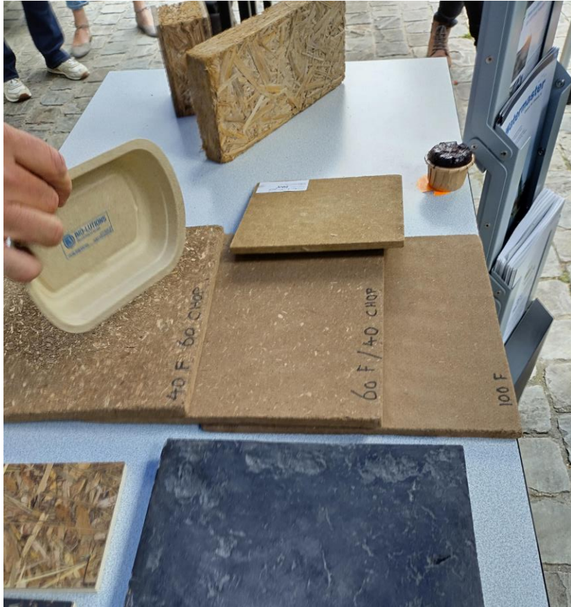
Rakennuslevyjä ja kertakäyttöastioita
